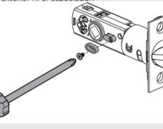
**F** Instale el pestillo usando (2) tornillos #8 x 3/4 pulgadas (19 mm).
