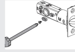
**F** Installez le loquet à l'aide de (2) vis #8 x 3/4 po (19 mm).
