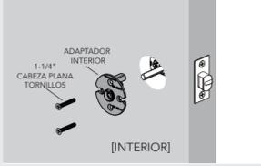
**J** Fije las rosas interiores y exteriores con el agujero en la rosa que da al pestillo de la puerta y enrosque el retenedor en el adaptador. Apriete de forma segura usando la llave inglesa proporcionada.
