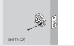
**M** Instale los tornillos de fijación suministrados en el interior y el exterior pomos o palancas. Deslice las arandelas de nailon sobre la base de las perillas o palancas. Desde el lado interior, empuje el husillo hasta el fondo para eliminar cualquier holgura. Instalar perilla o palanca exterior mientras empuja el husillo, el interior. Asegure la perilla o palanca exterior con tornillo de fijación.
