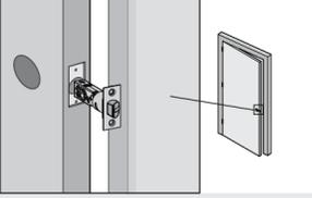
**D** Tout en maintenant le loquet de la porte avec le côté biseauté du pêne face au cadre de la porte, ajustez la bascule sur la position L supérieure pour leviers ou la position K du milieu pour les boutons.
