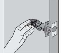
**B** Est-ce que le trou en forme de diamant sur le loquet est centré dans le trou de la porte? OUI: Trou en forme de diamant. Aucun ajustement n'est requis. Passez à l'étape suivante. NON: Trou en forme de diamant. Faites pivoter la face du loquet comme indiqué pour étendre le loquet.
