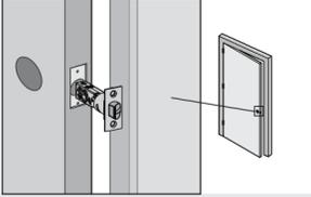
**D** Mientras sostiene el pestillo de la puerta con el lado biselado del cerrojo que mira hacia el marco de la puerta, ajuste la palanca a la posición L superior para palancas o la posición K central para las perillas.
