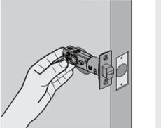
**B** ¿Es el orificio en forma de diamante en el pestillo centrado en el orificio de la puerta? SÍ: Agujero en forma de diamante. No se requiere ningún ajuste. Continúe con el siguiente paso. NO: Agujero en forma de diamante. Gire la cara del pestillo como se muestra para extender el pestillo.
