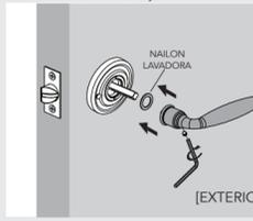
**N** Instale la perilla o palanca interior. Asegure la perilla o palanca interior con un tornillo de fijación.
