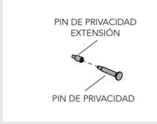
**L** Inserte el pasador de privacidad en el orificio en la roseta interior hacia el borde de la puerta y enrosque en el cerrojo.
