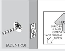
**H** Instale el adaptador exterior con las palabras "Door Jamb" señalando hacia la jamba donde se encuentra la huelga se instalará. Si utiliza el adaptador asistido por resorte en el caso de las palancas, asegúrese de que el soporte esté colocado. El husillo sobresale a través del adaptador.
