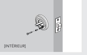
**M** Installez les vis de réglage fournies à l'intérieur et à l'extérieur boutons ou leviers. Faites glisser les rondelles en nylon sur la base des boutons ou des leviers. Du côté intérieur, appuyez sur le bouton broche à fond pour éliminer tout jeu. Installer bouton ou levier extérieur tout en appuyant sur la broche intérieur. Fixez le bouton ou le levier extérieur avec vis de réglage.
