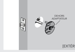
**I** Installez l'adaptateur intérieur avec les mots "Door Jamb" pointant vers le montant où la gâche sera installée. Utilisez les vis de 1 1/4 po (32 mm) pour fixer. La broche dépasse à travers l'adaptateur.
