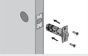
**G** Du côté intérieur de la porte, insérez complètement le long terminet la broche dans le loquet de manière à ce que les oreilles de chien sur la broche soient contre le corps et que la rainure soit orientée vers le bas vers la charnière inférieure des deux côtés de la porte.
