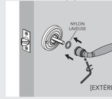
**N** Installez le bouton ou le levier intérieur. Fixez le bouton ou le levier intérieur avec une vis de réglage.
