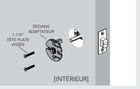
**J** Fixez les rosaces intérieures et extérieures avec le trou dans la rosace face au loquet de la porte et enfiler le sur l'adaptateur. Serrez solidement à l'aide de la clé fournie.
