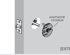
**I** Instale el adaptador interior con las palabras "Door Jamb" apuntando hacia la jamba donde se instalará la cerradura. Use los tornillos de 1-1/4 pulgadas (32 mm) para asegurarlos. El husillo sobresale a través del adaptador.
